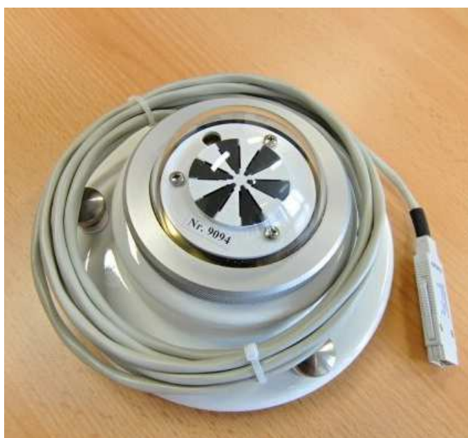
Obr.12.4: Pyranometr FLA628S s inteligentním konektorem.
