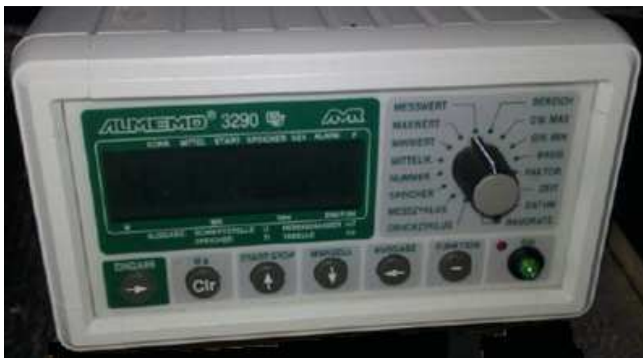
Obr.12.1: Měřicí ústředna Almemo 3290-8.
