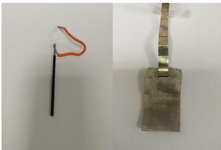
Obr. 15 Vlevo referenční elektroda, vpravo protielektroda.
