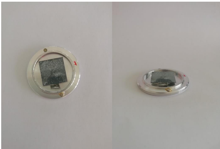
Obr. 11 Umístění vzorku v držáku pro měření pomocí XRD.
