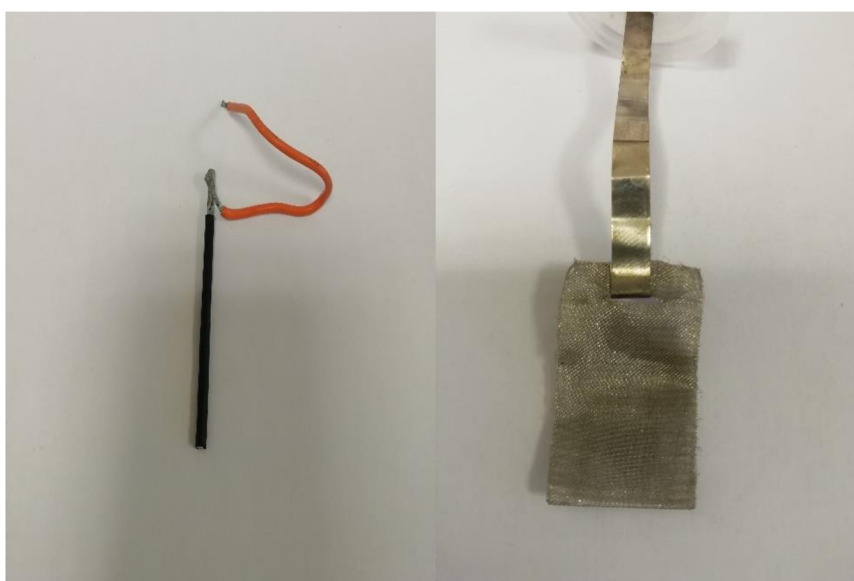
Obr. 15 Vlevo referenční elektroda, vpravo protielektroda.
