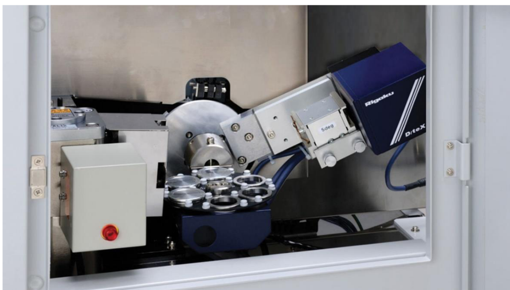
Obr. 10 Součásti rentgenového difraktometru Rigaku MiniFlex 600 HR. Převzato z [47].
