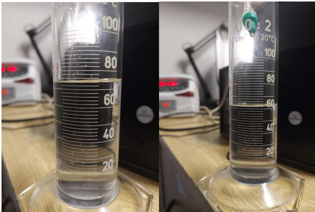
Obr. 19 Měření infuzní pumpy Argus 707 – rychlost dávkování 25 ml/hod
