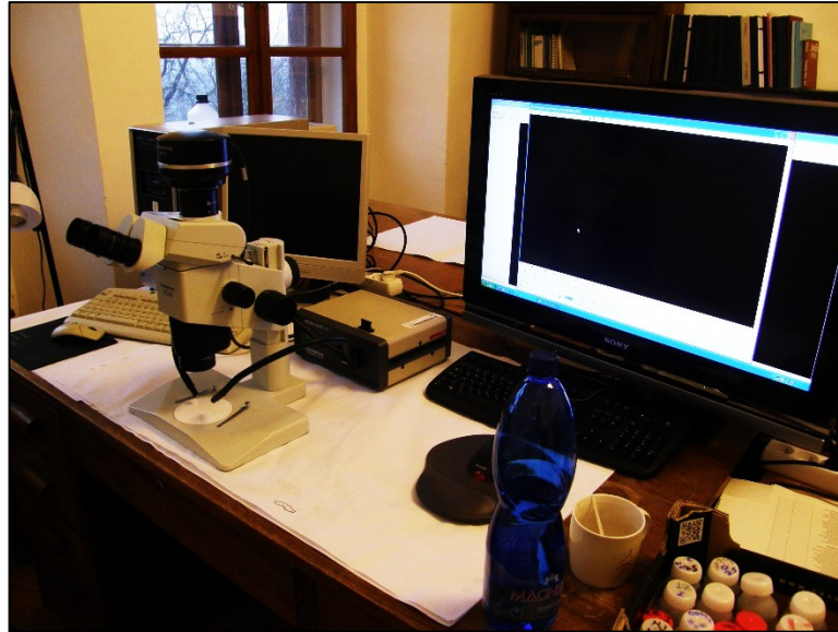
Foto č. 10: Stereomikroskop Olympus SZX7 s přídavnou kamerou DP72 v laboratoři aplikované ekologie ČZU-FŽP v Kostelci nad Černými lesy.
