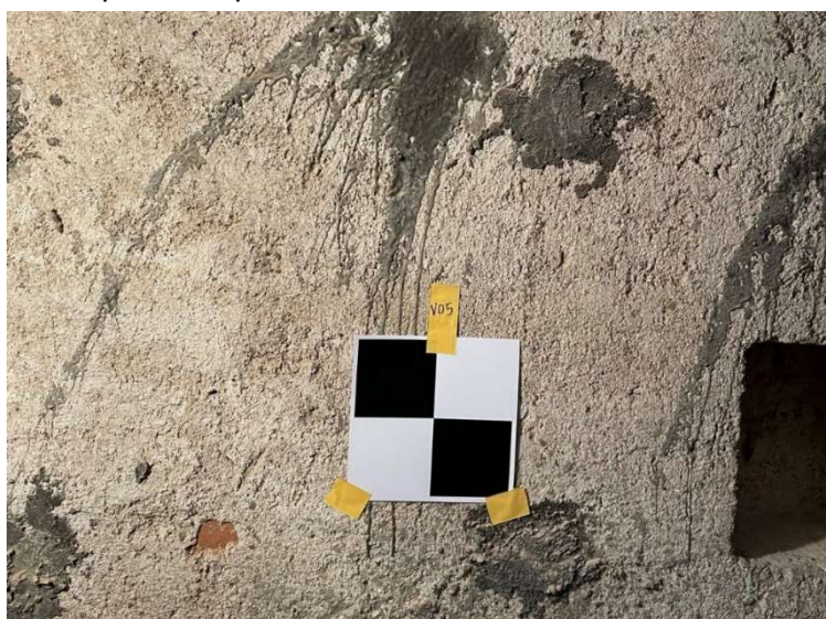
Obr. č. 12: Způsob stabilizace VB5 pomocí šachovnicového terče a PVC pásky, [Autor]
