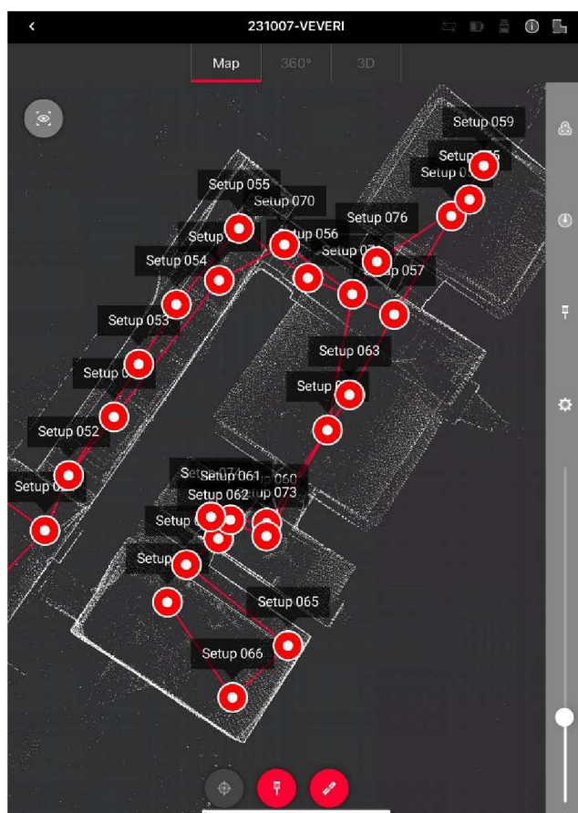
Obr. č. 17: Před-registrované skeny s viditelnými pozicemi skeneru a jejich návaznostmi, Leica Cyclone Field 360, [Autor]
