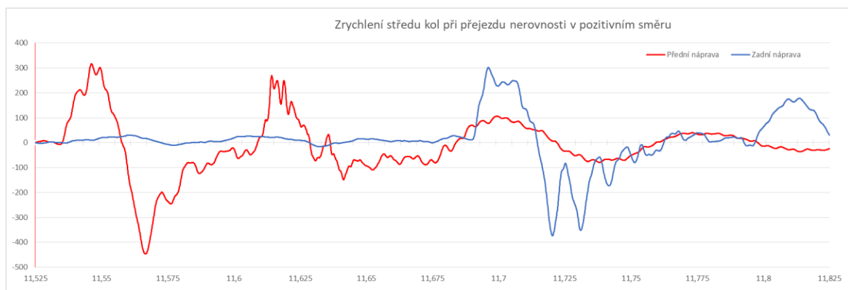
Obrázek 38: Zrychlení středu kol při jízdní zkoušce při přejezdu nerovností v pozitivním směru
