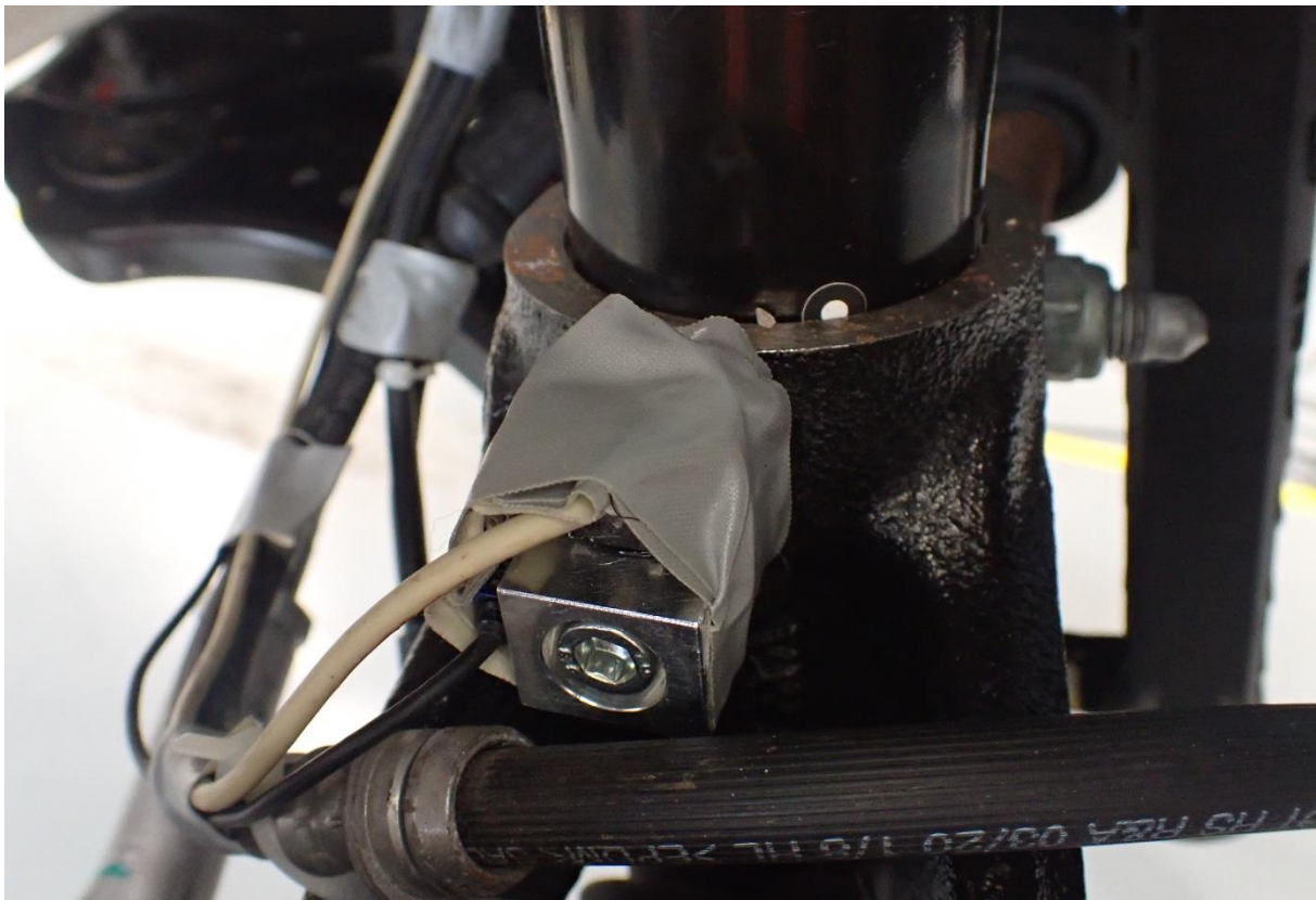
Obrázek 33: Detail uložení snímače na těhlici přední nápravy
