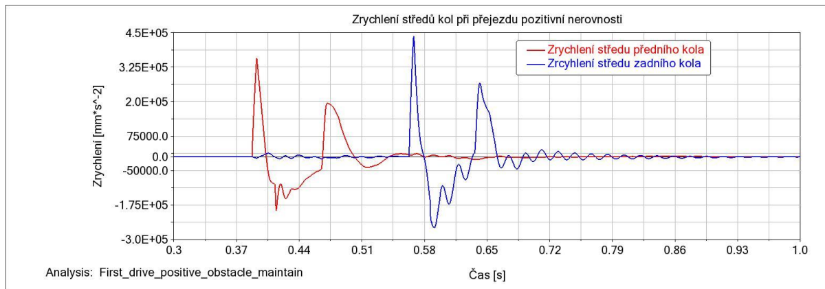
Obrázek 29: Průběh zrychlení středů kol náprav při přejezdu pozitivní nerovnosti
