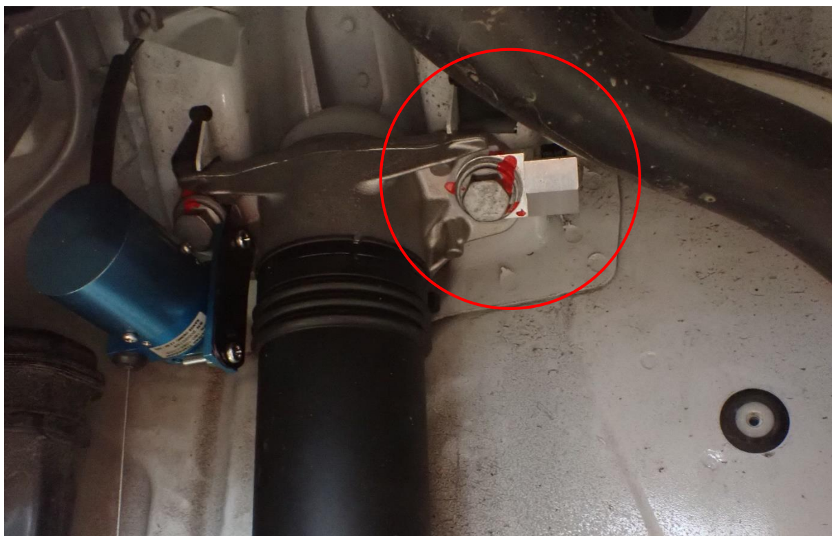
Obrázek 35: Uložení snímače na zadním tlumiči pro sledování zrychlení karoserie
