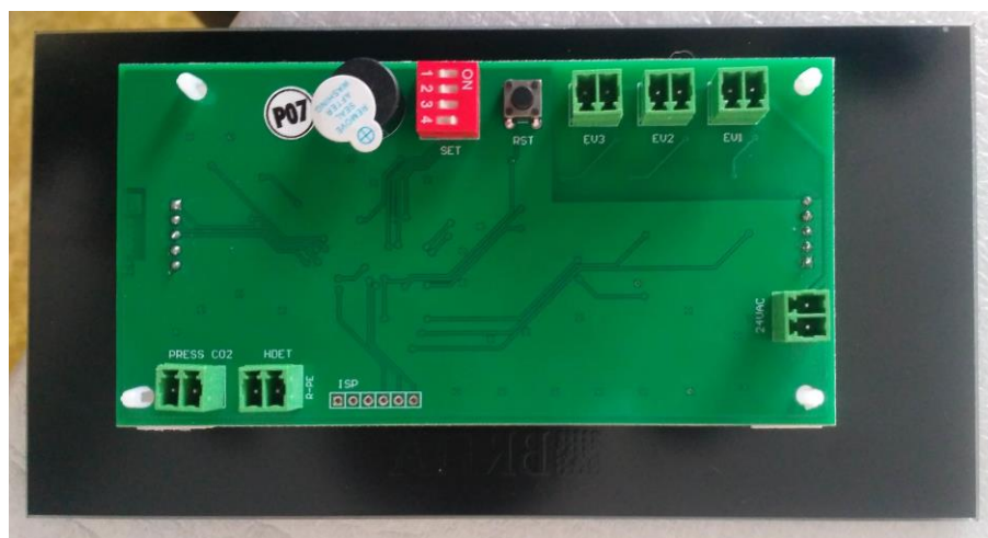
Obr. 6.2.3: Zkompletovaný modul sodobaru S200N
