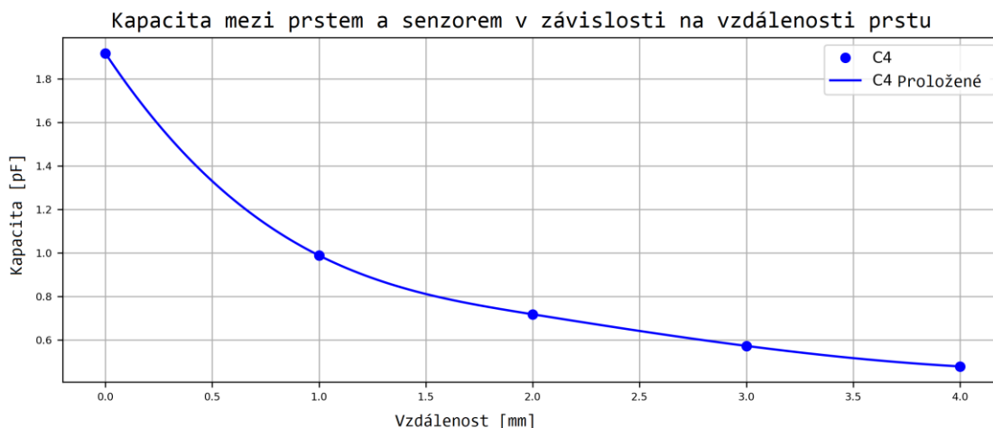
Obr. 5.3.3: Závislost kapacity prostředního senzoru na vzdálenosti prstu
