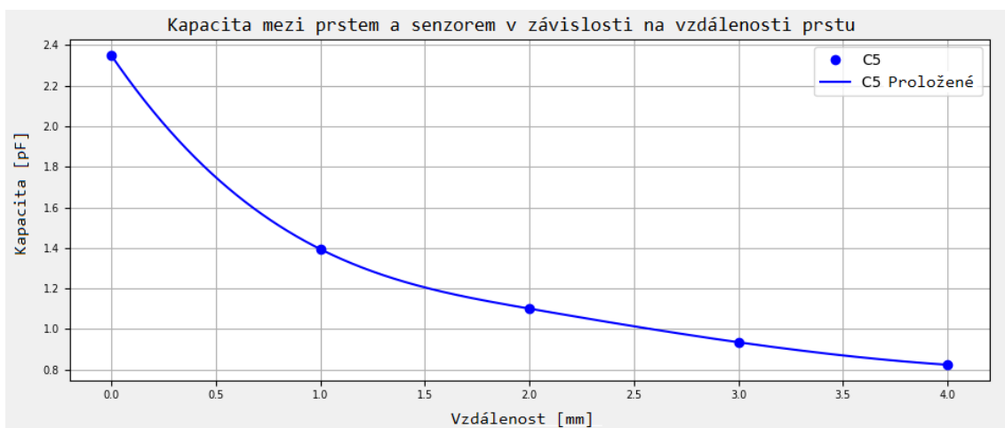
Obr. 5.3.2: Závislost kapacity senzoru na vzdálenosti prstu
