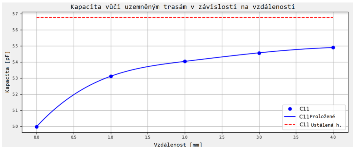
Obr. 5.3.5: Závislost kapacity vůči uzemněným trasám v závislosti na vzdálenosti prstu
