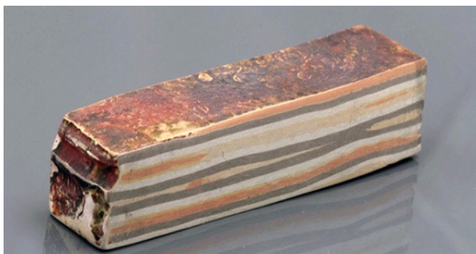
Obr. 6.5.1.2 Nevybroušený polotovar mokumé gane [38]
