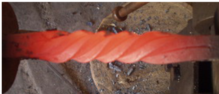
Obr. 6.4.2.1 Torzování ocelových prutů [35]
