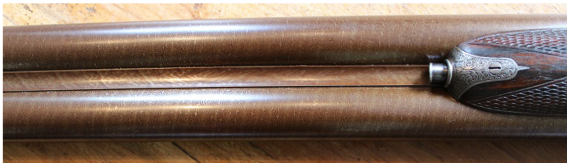
Obr. 6.4.2.2 Damascenská hlaveň zalamovací brokovnice [36]
