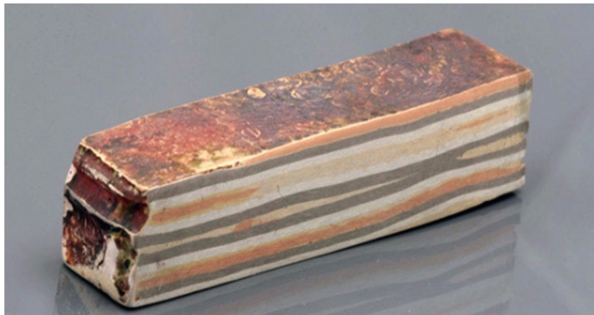
Obr. 6.5.1.2 Nevybroušený polotovar mokumé gane [38]
