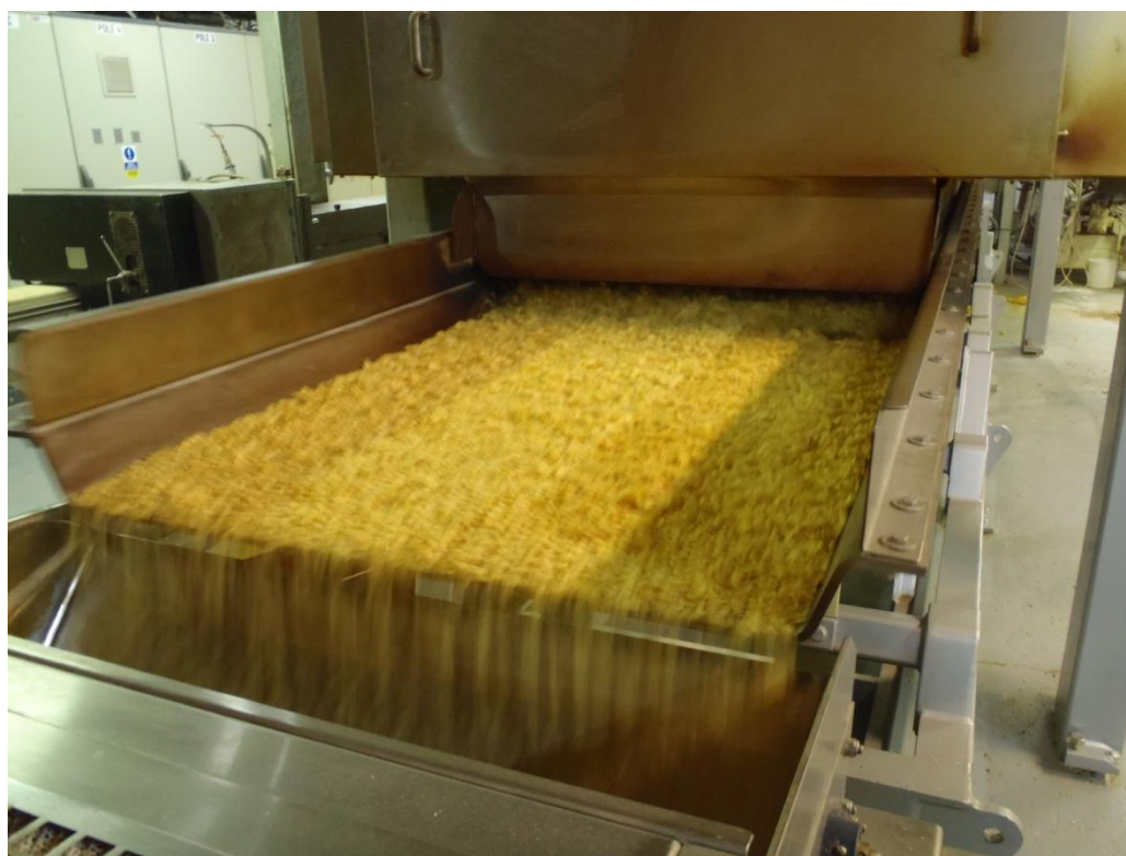
Obr. č. 8P Pohled na výstup z fluidní sušárny
