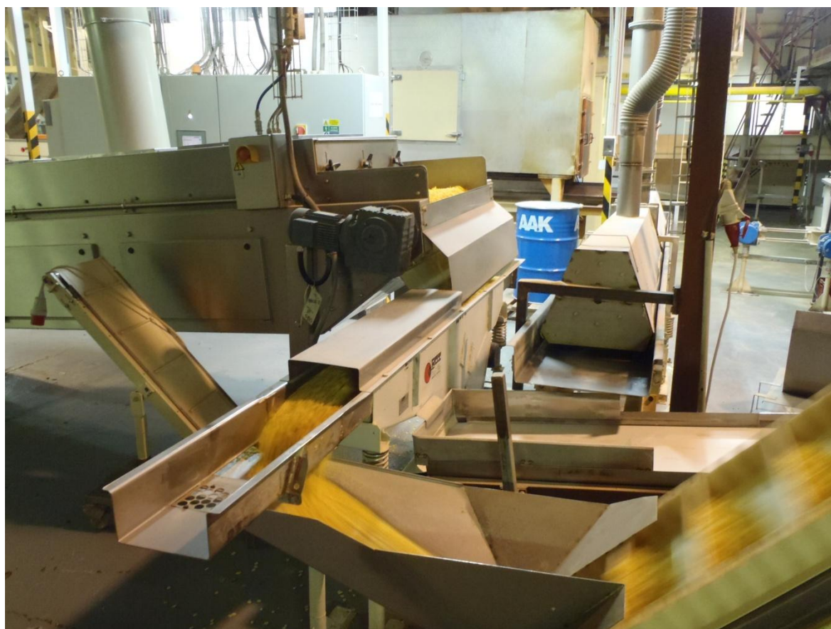
Obr. č. 11P Výstup z chladícího pásu a doprava cornflakes na balení
