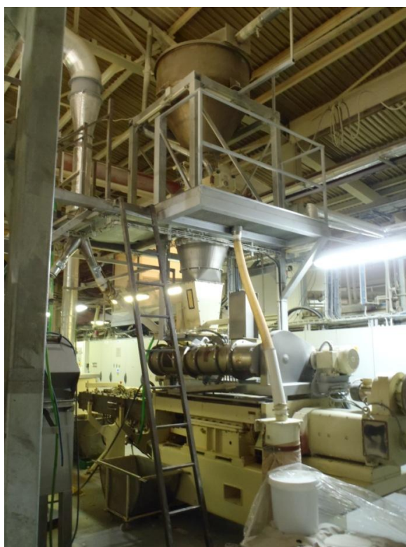
Obr. č. 2P Pohled na sestavu extrudéru, od shora: přijímová míchačka, prosévačka, dvoušnekový dávkovač, předkondicionér
