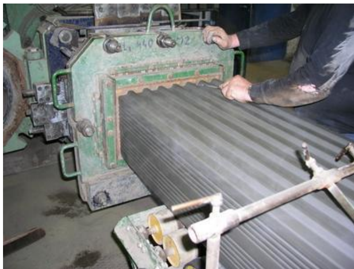
Obr. č. 31: Výroba cihel protlačováním Foto M. Vavro 2004 (cihelna Hrachovec)
