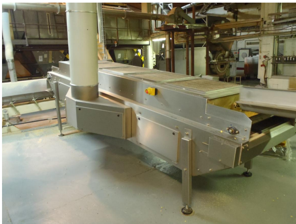
Obr. č. 10P Chladící pás
