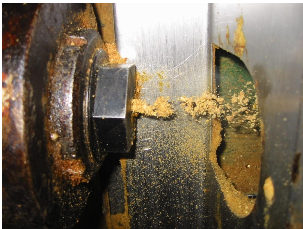
Obr. č. 14P Pohled na dýzu při extruzi krmivářské sóji ( extrudér Farmet umístěný ve firmě Pragosoja )
