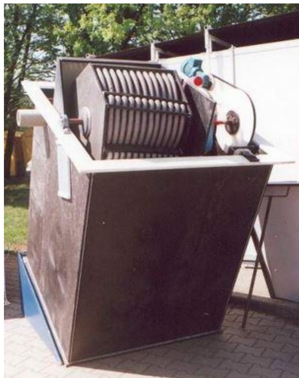
Obrázek 29 - DČOV s biodisky typ MICRO ( http://www.aquatech.cz/ )
