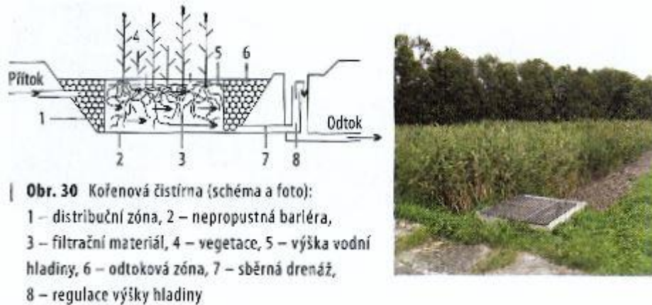
Obrázek 6 - Schéma kořenové čistírny + foto (Sojka 2013)
