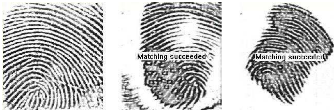
Obr. 20: Zleva: živý prst, želatinový prst a prst ze zinkoklihu.
