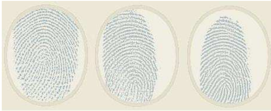
Obr. 17: Zleva: živý prst, želatinový prst a prst ze zinkoklihu.
