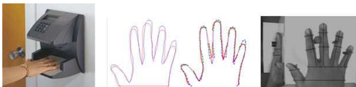
Obr. 8: Snímání geometrie ruky. [14]
