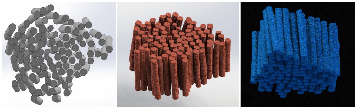
Obr. 5.8 Vytažený 3D model soustavy vlákně příze (vlevo), izometrický náhled na sestavu vláken (uprostřed), izometrický náhled na vznikající zákrut (vpravo)
