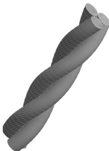
Obr. 2.1 Model kontinua s dělením na menší prvky [24]
