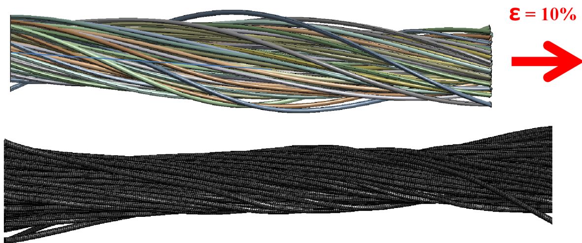
Obr. 7.2 Výsledky deformace pokročilého modelu vlákněné příze při tahovém namáhání
