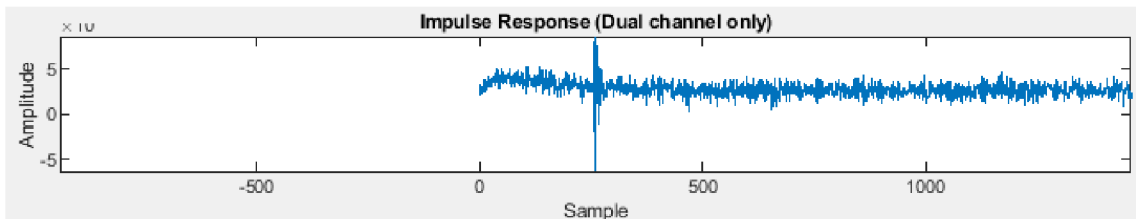
Obr. 3.15: Dvoukanálová analýza, impulsní odezva, mikrofon jeden metr od reprosoustavy
