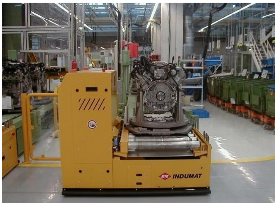
Obr. 14 Vozík s palubným dopravníkom [22].
