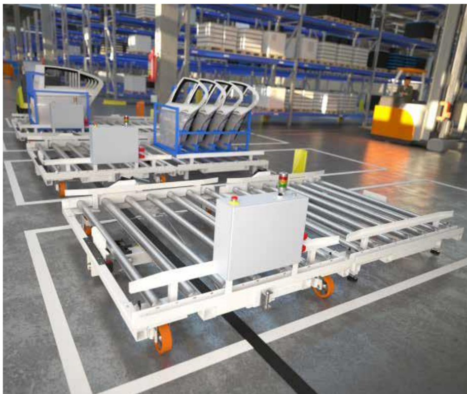
Obr. 19 Ťahací AGV vozík s valčekomými dopravníkmi [26].
