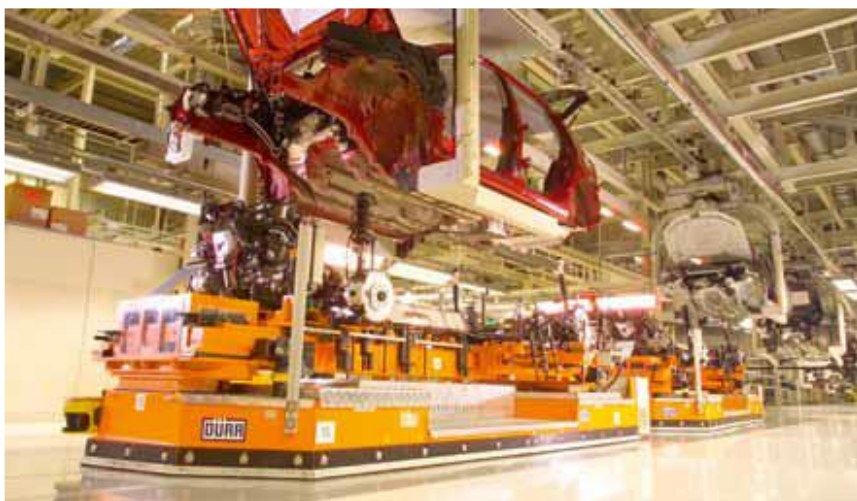
obr. 29 Montáž karosérie s podvozkom [21].
