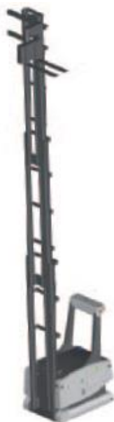
Obr. 13 Vysokozdvihový vozík vidlicový s bočným ložením [13].
