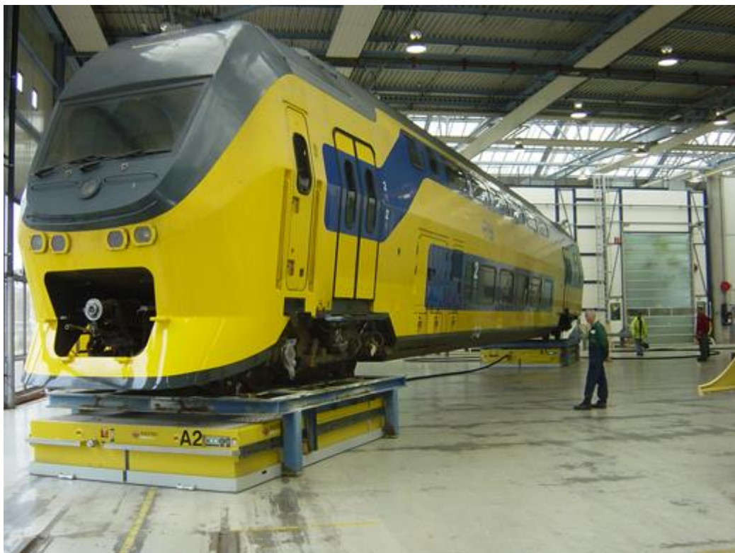
Obr.24 Manipulácia s vagónom pomocou vzduchového vankúša [34].
