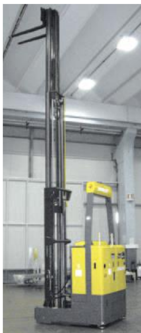
Obr. 12 Vysokozdvížený vidlicový vozík pre veľké výšky [13].
