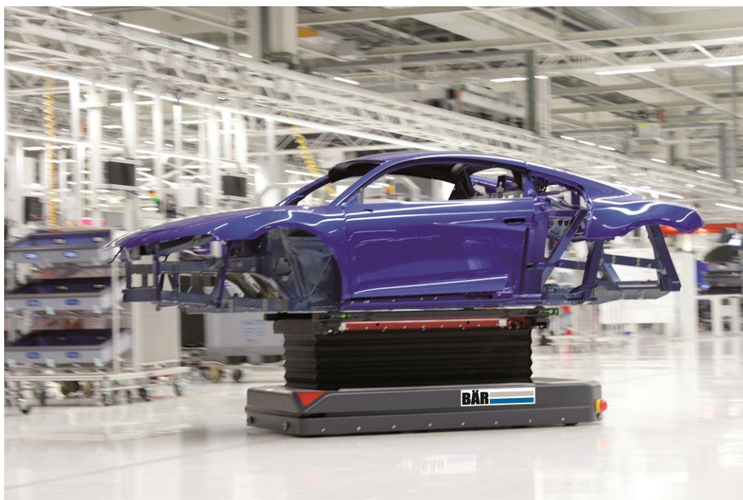
Obr. 16 Montážny vozík v automobilovom priemysle [24].
