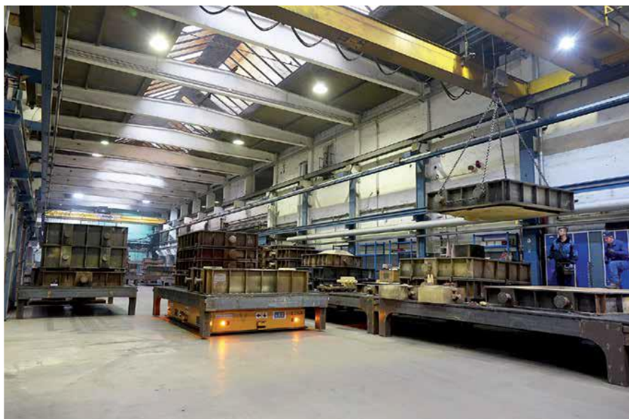
Obr. 26 Automatizovaný vozík vo formovni [37].
