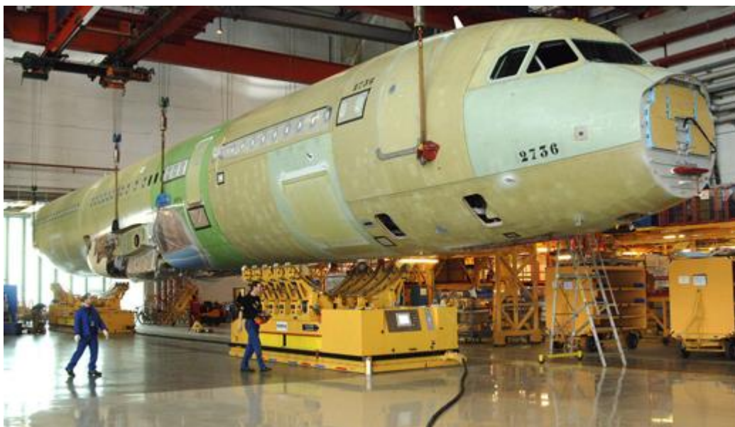
Obr.31 Preprava trupu pomocou vzduchových vankúšov [40].
