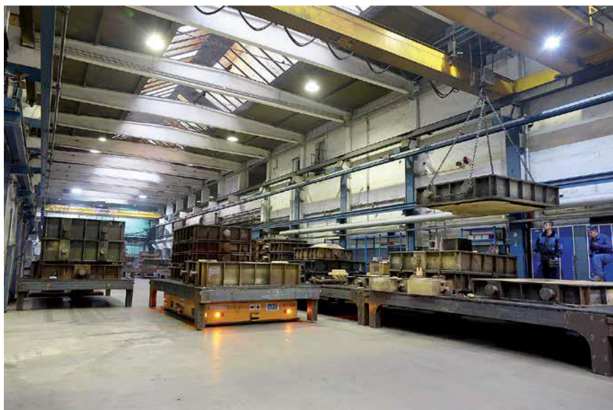
Obr. 26 Automatizovaný vozík vo formovni [37].
