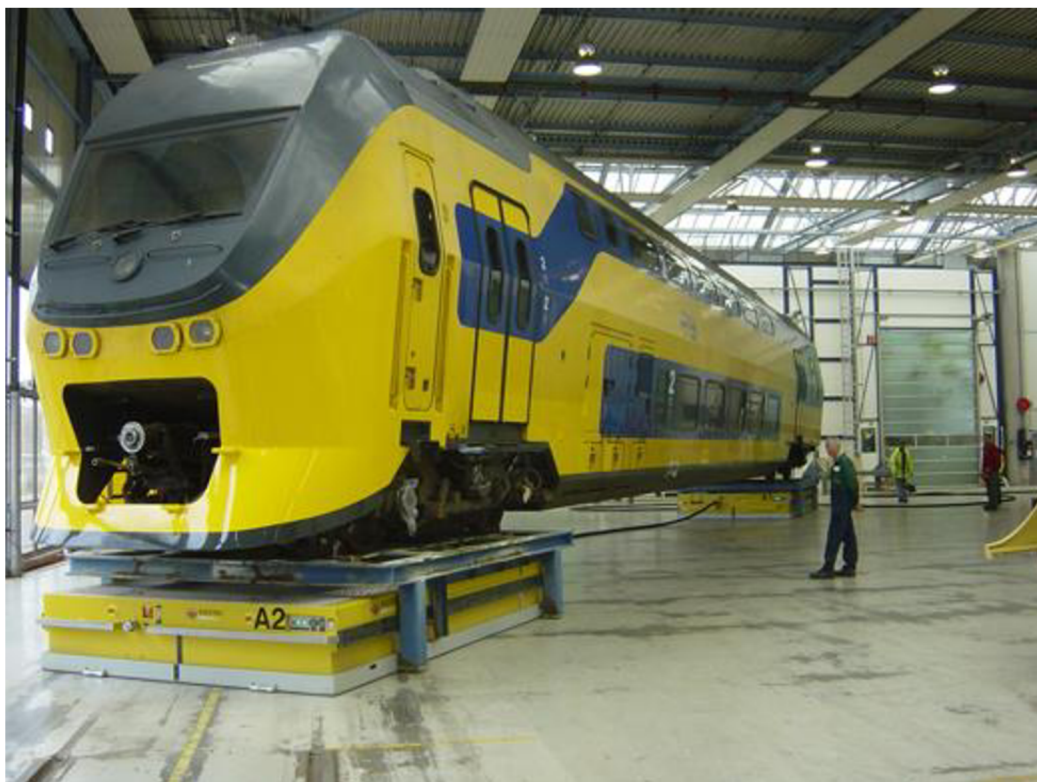
Obr.24 Manipulácia s vagónom pomocou vzduchového vankúša [34].
