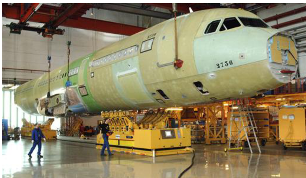
Obr.31 Preprava trupu pomocou vzduchových vankúšov [40].
