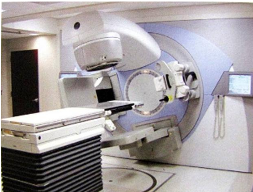
Obrázek 7 Zdokonalený lineární urychlovač umožňující techniku IGRT
