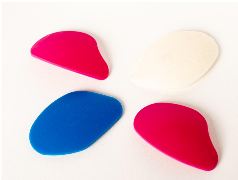
Obrázek 35 Krycí oční insert vytištěný v jednotlivých vývojových stupních pomocí technologie FDM
