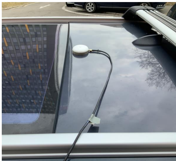
Obr. 34 Upevnění GNSS antény na střeše vozidla
