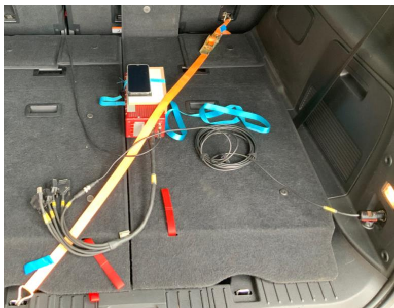
Obr. 41 Upevnění měřicího zařízení v automobilu
