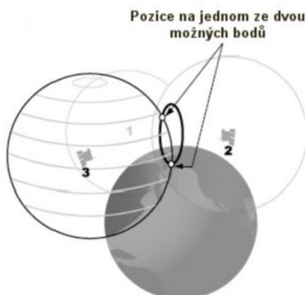
Obr. 28 Princip určování pozice GPS [28]
