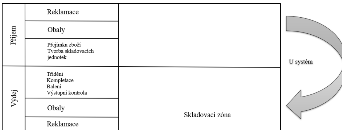
Obr. 1.7 U systém uspořádání skladů
