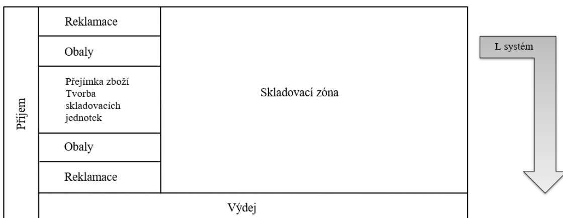
Obr. 1.8 L systém uspořádání skladů
