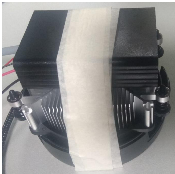
Obr. 5.5 Rudimentární teplotní komora
