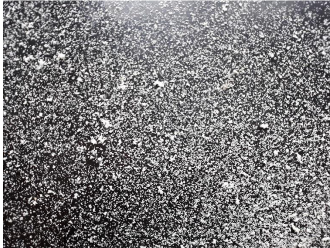
Obrázek 28 výsledek mechanické recyklace lamelového brusného kotouče a brusného pásu
