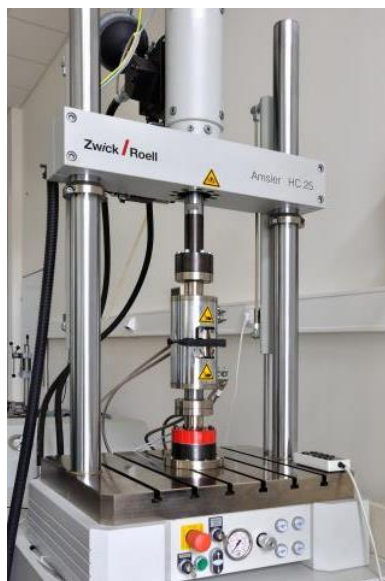
Obrázek 44 Servohydraulický pulsátor Zwick/Roell Amsler HC25, tah-tlak – z důvodu zákazu focení v laboratořích PROSEAT. Obrázek převzat ze stránek AV [19]
