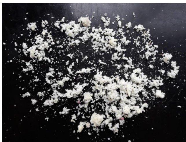
Obrázek 22 Výsledek mechanické recyklace pomocí drátěného kotouče
