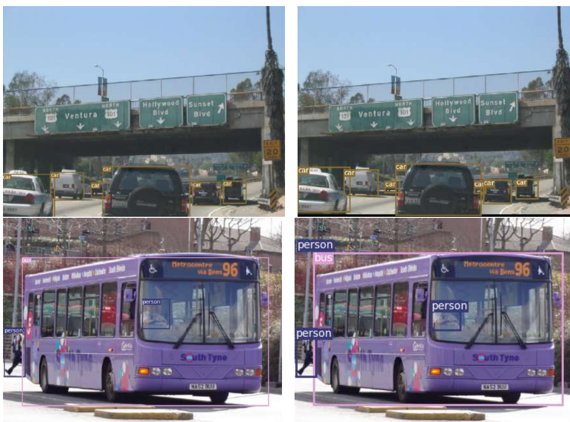
Obr. 35: Srovnání detekcí a anotací. Vlevo je detekce sítě, vpravo naanotovaná fotka [26]
