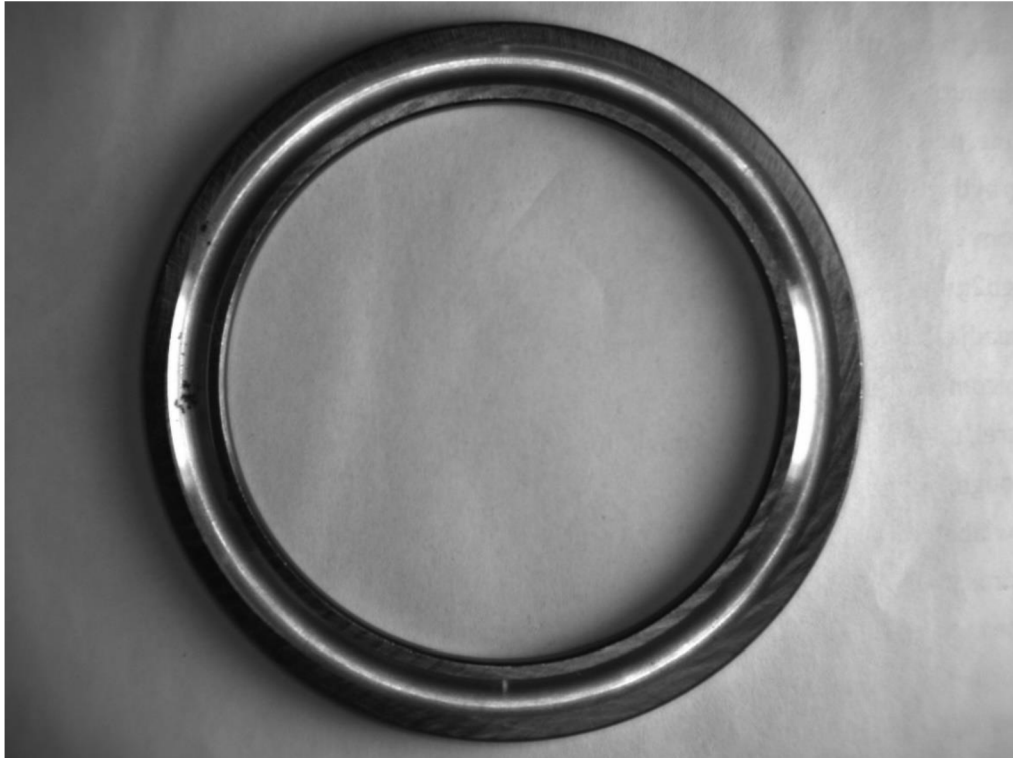
Obr. 5.6 Příklad snímku ložiska při použití kruhového světla shora i světelného panelu z boku
