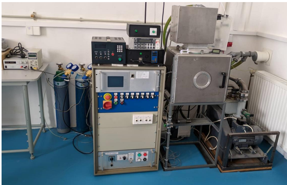
Obrázek 12: Používaná nízkotlaká mikrovlnná plazmová aparatura CX-22.
