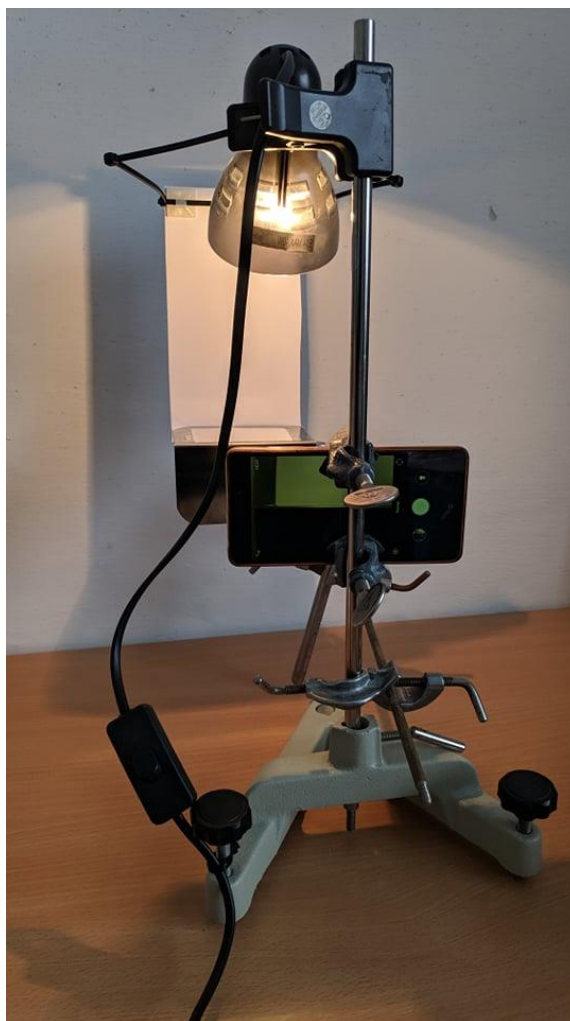
Obrázek 18: Sestava pro měření smáčivosti kapkovou metodou.
