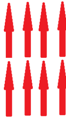
Obr.3.1: Schématické znázornění natočení magnetických momentů feromagnetické látky po vstupu do magnetického pole.
