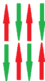
Obr.2.2: Schématické znázornění natočení magnetických momentů antiferomagnetické látky po vstupu do magnetického pole.
