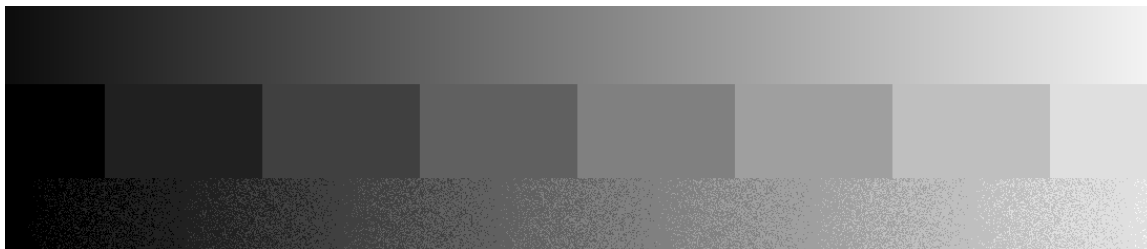
Obrázek 4.6: Ukázka bandingu a ditheringu. Ve vrchní části obrázku je přechod z černé do bílé. V prostřední části je ten samý přechod, jen s nedostatečnou přesností. Ve spodní části je přechod se stejnou přesností jako prostřední, ale šum v přechodu dodává pocit plynulejšího přechodu.
