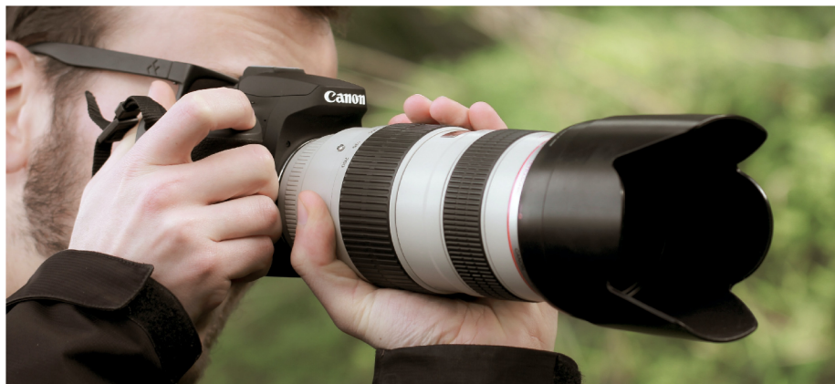
Obrázek 2.2: Sluneční clona. Výřezy ve cloně jsou z důvodu zorného pole fotoaparátu. 1
