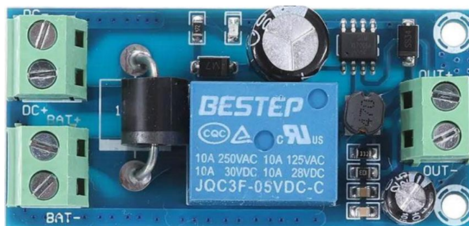
Obrázek 3 Automatický přepínač baterie - UPS modul YX850 (12)
