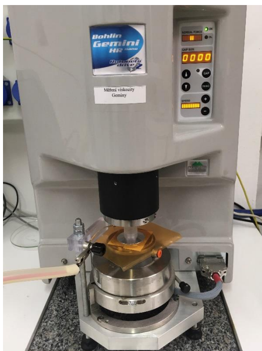
Obrázek 38: Měření vlivu elektrického pole na viskozitu roztoků pomocí upraveného viskozimetru
