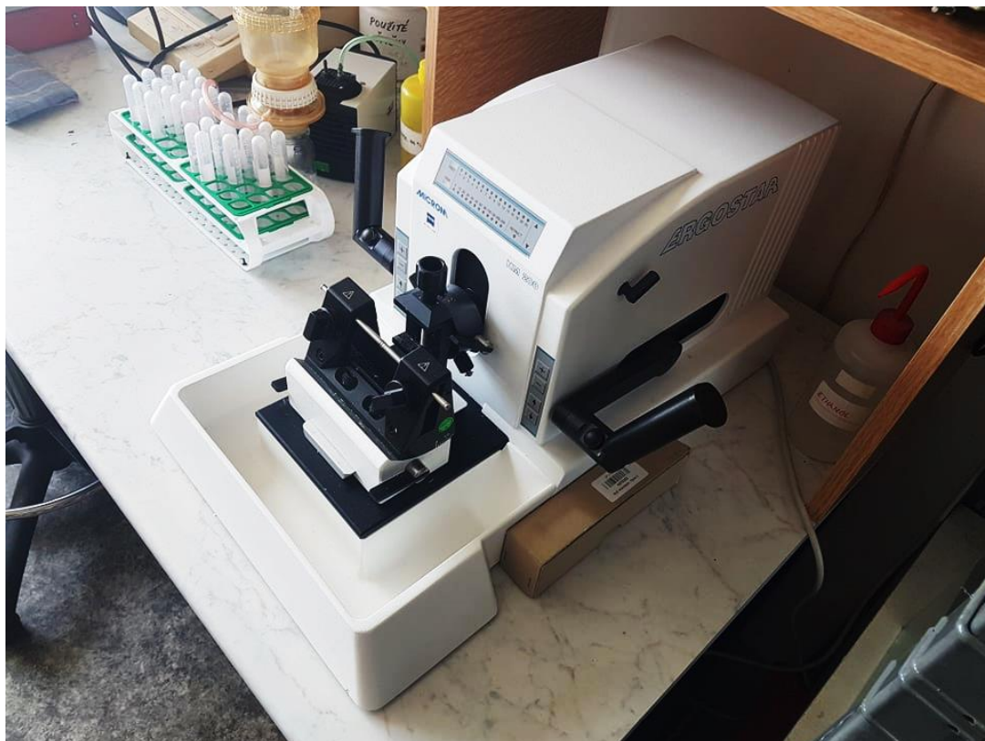
Příloha 6 – Sáňkový mikrotom ERGOSTAT MICROM HM 200
