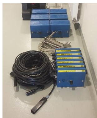
Obr. 3. 7. Příprava na instalaci průtokoměrů (foto: Jakub Lžičář)
