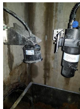
Obr. 3. 18. Osazení hladinoměrů ISCO a IJINUS (foto: Jakub Lžičař)
