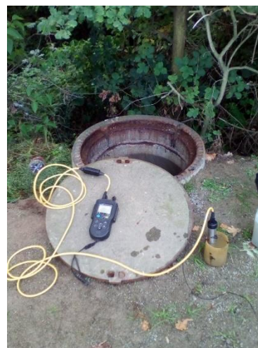
Obr. 3. 20. Vyhodnocení bodového odběru vzorku jakosti odpadní vody (foto: Jakub Lžičař)
