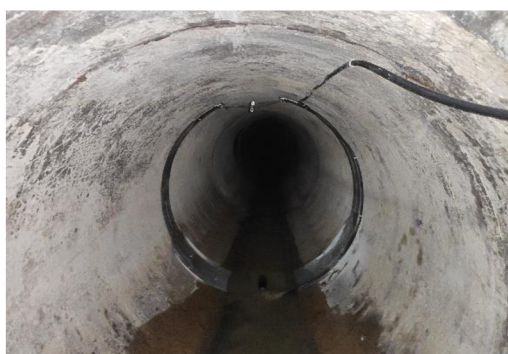
Obr. 3. 10. Osazený AV senzor ve stoce (foto: autor)
