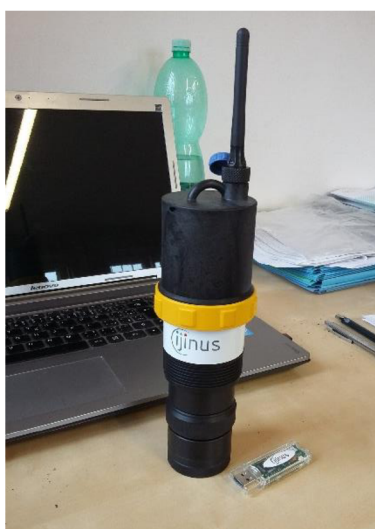
Obr. 3. 16. Hladinoměr IJINUS (foto: Jakub Lžičař)
