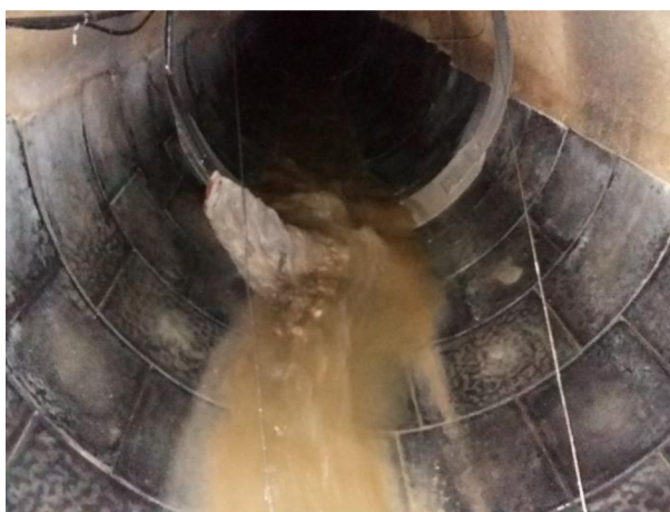
Obr. 3. 13. Zanesení AV senzoru (foto: Jakub Lžičař)
