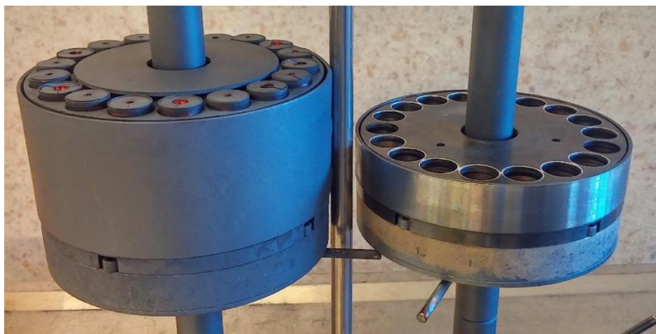
Obrázek 2.3: Fotografie porovnávaných držáků. Vlevo je původní s vyšším objemem a tepelnou kapacitou. Vpravo je nový s nižší tepelnou kapacitou. Oba jsou vyrobeny ze stejného materiálu.
