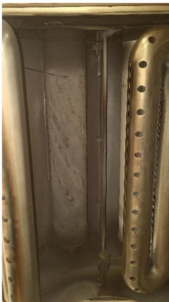
Obrázek 1.2: Fotografie grafitové katody instalované ve dveřích povlakovací komory.
