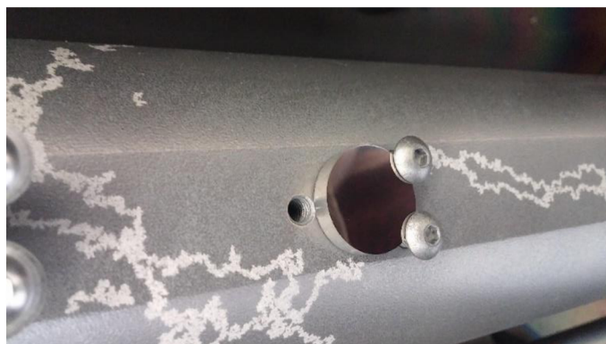
Obrázek 1.4: Důsledek působení mikrooblouku na tepelné jímce (světlé mapy na tepelné jímce).
