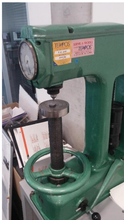
Obrázek 2.7: Fotografie zařízení pro Mercedes test.
