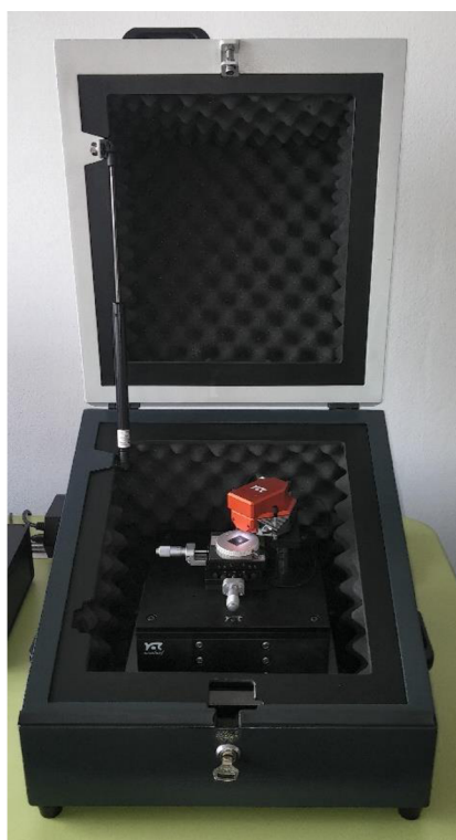
Obrázek 2.4: Fotografie přístroje NanoSurf NaniteAFM s nádstavbou IsoStage Controller.
