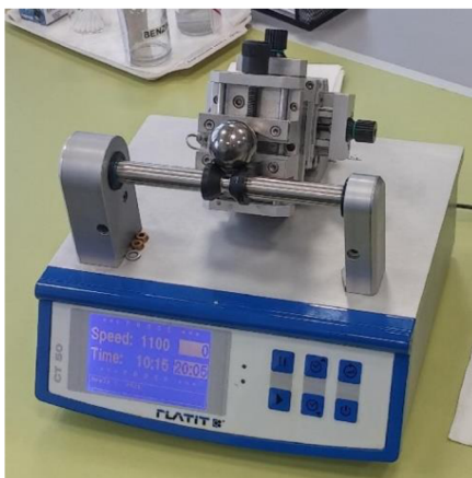
Obrázek 2.8: Fotografie přístroje Calotest CT50.
