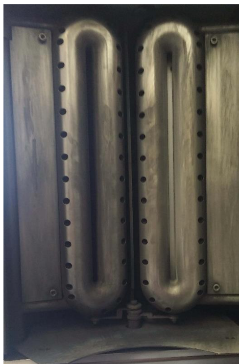
Obrázek 2.2: Fotografie filtru makročástic ve dveřích povlakovací komory.
