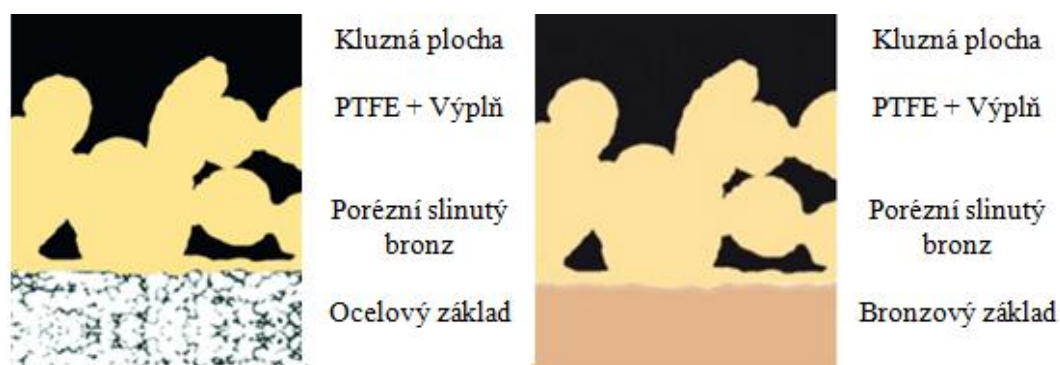
Obrázek 7: Příklad složení dvou různých pouzder s popisem vrstev [10]
