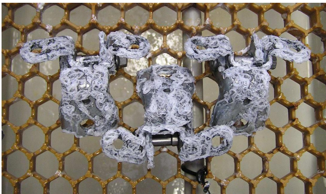
Obrázek 10: Díly po skončení testu s patrnou bílou korozí [4]
