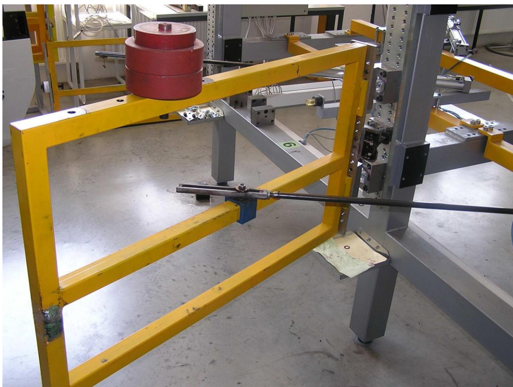
Obrázek 11: Zařízení používané na životnostní testy závěsů [4]
