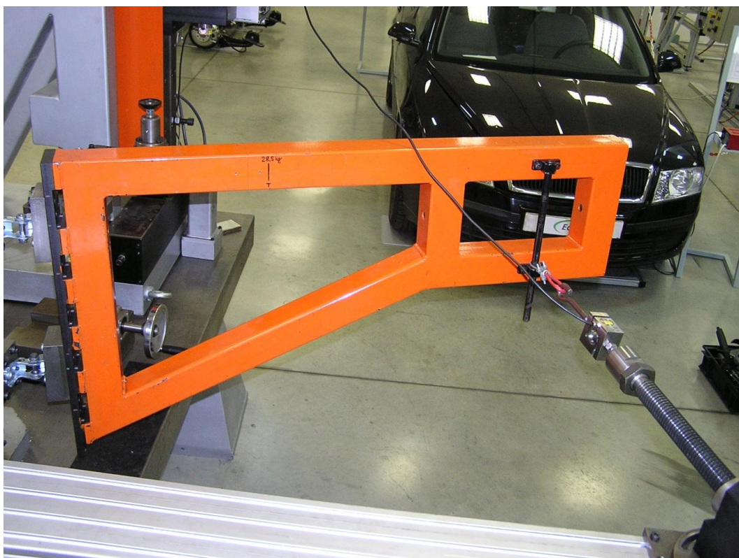
Obrázek 9: Zařízení pro testování koncového dorazu závěsu [4]
