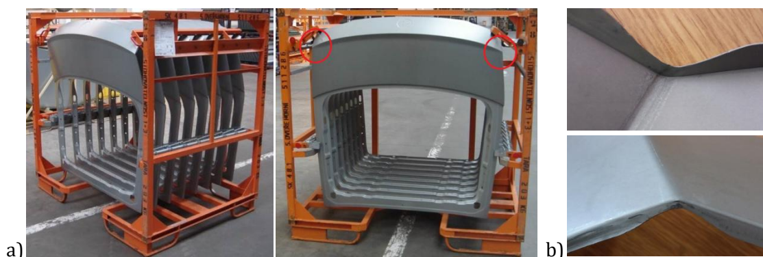
Obr. 29: Výtažek pátých dveří automobilu Škoda Superb III
