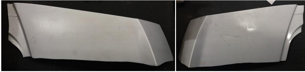
Obr. 40: Polotovary pro přípravu zkušebních vzorků odebrané z reálných součástí
