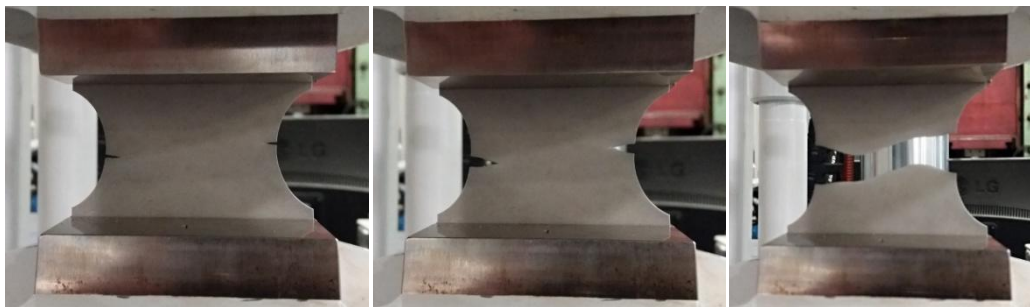
Obr. 39: Vznik únavové trhliny
