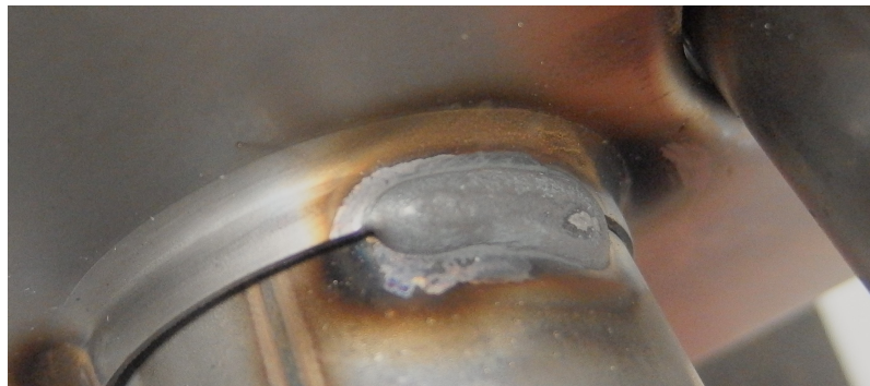
Obrázek 40: Proces microMIG-cc, svar č. 5 koutový jednovrstvý přeplátovaný
