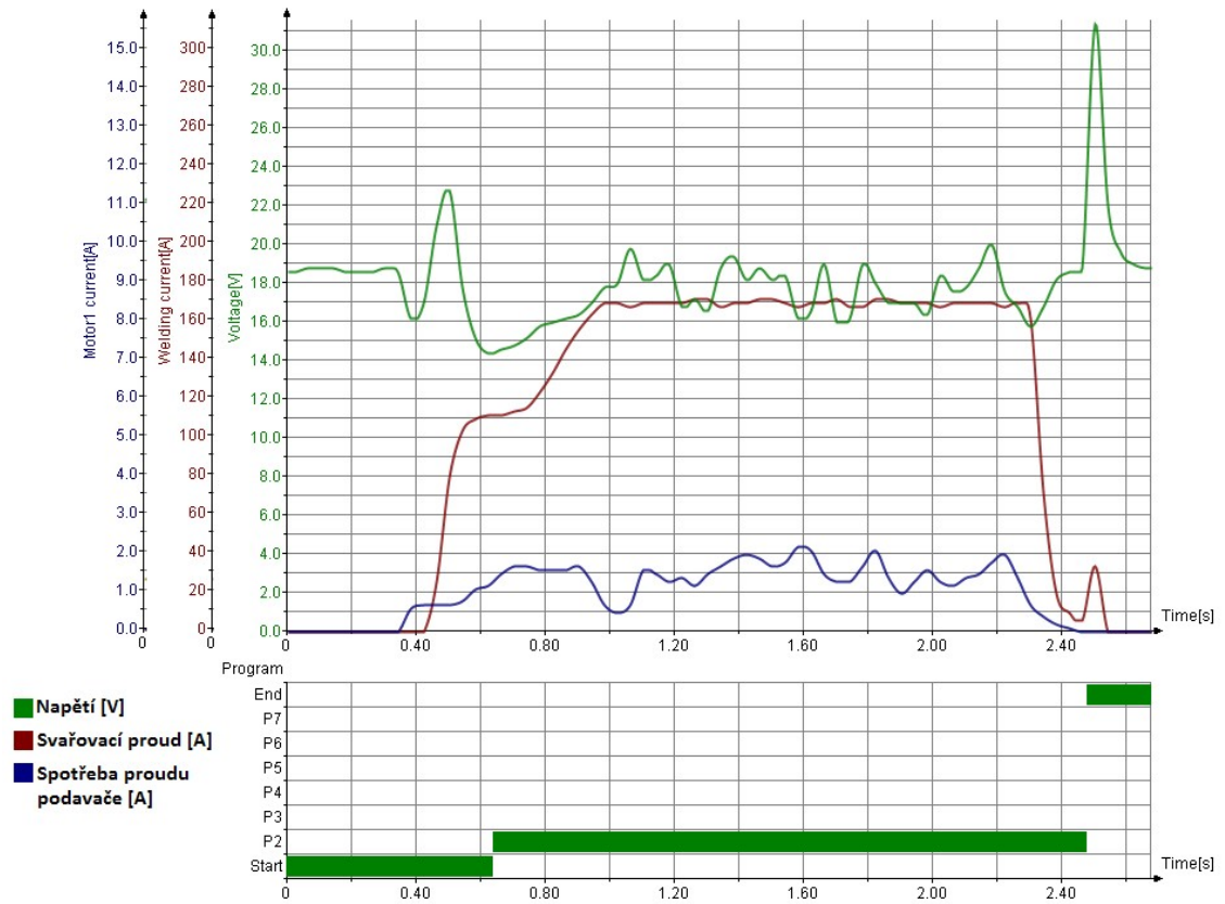
Obrázek 37: Grafický záznam parametrů microMIG, svar č. 1, program P2 [16]
