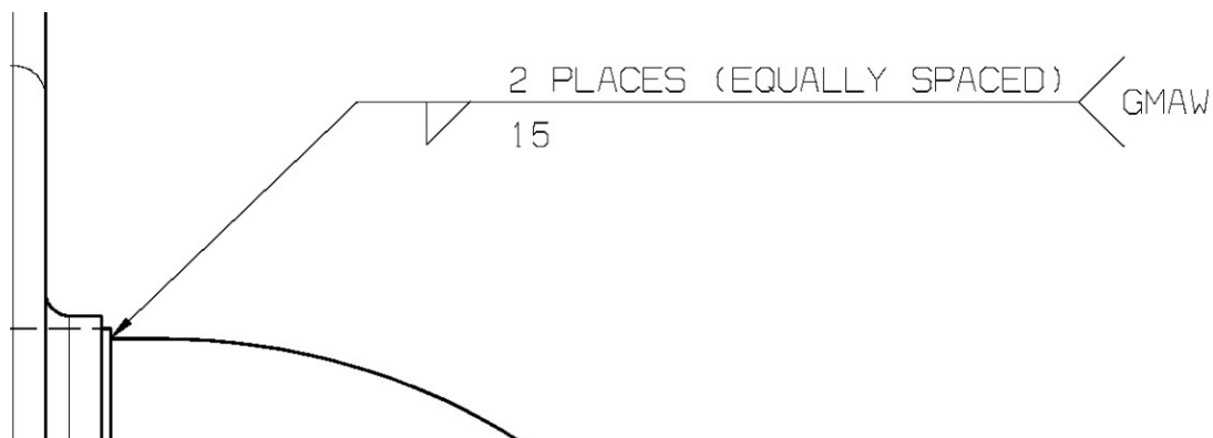
Obrázek 26: Místo 1 a 6 - koutový svar vícevrstvý přeplátovaný [18]
