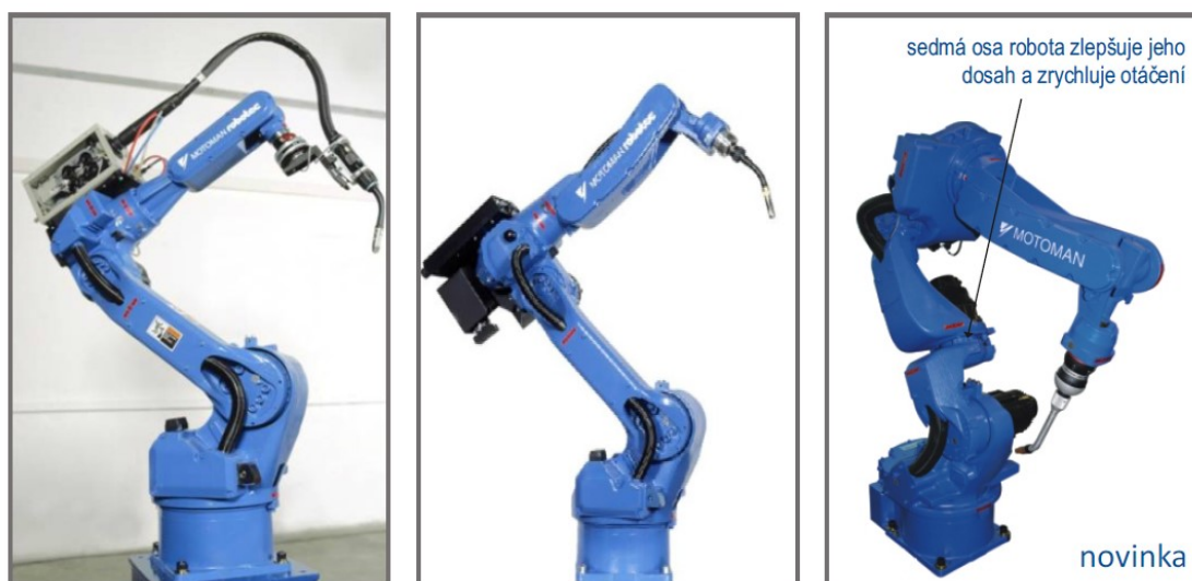
Robot HP20D - klasický univerzální 6-osý robot s vedením kabeláže svařovacího hořáku vně horního ramene robota.
