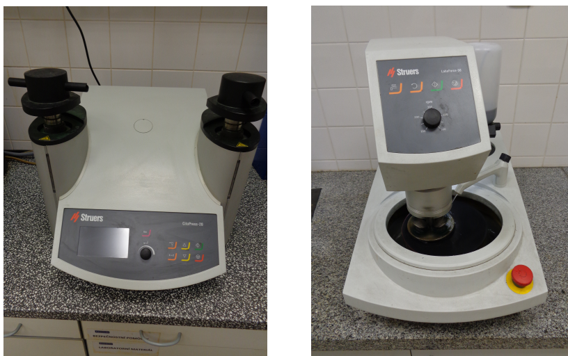
Obrázek 43: Lis CitoPress-20 (vlevo) a leštička LaboForce-50 (vpravo)
