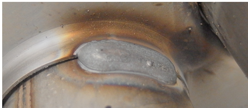
Obrázek 32: Proces MIG/MAG, svar č. 5 koutový jednovrstvý přeplátovaný
