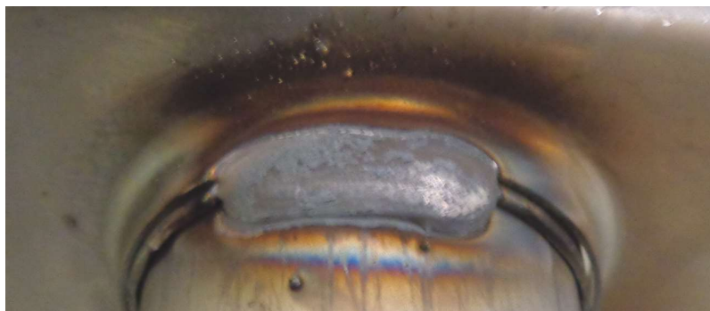
Obrázek 30: Proces MIG/MAG, svar č. 1 koutový vícevrstvý přeplátovaný
