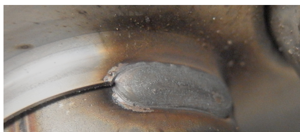
Obrázek 36: Proces KF-PULS, svar č. 5 koutový jednovrstvý přeplátovaný
