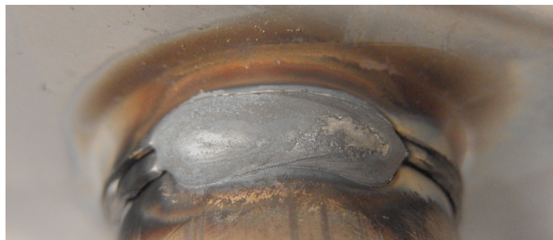
Obrázek 38: Proces microMIG-cc, svar č. 1 koutový vícevrstvý přeplátovaný
