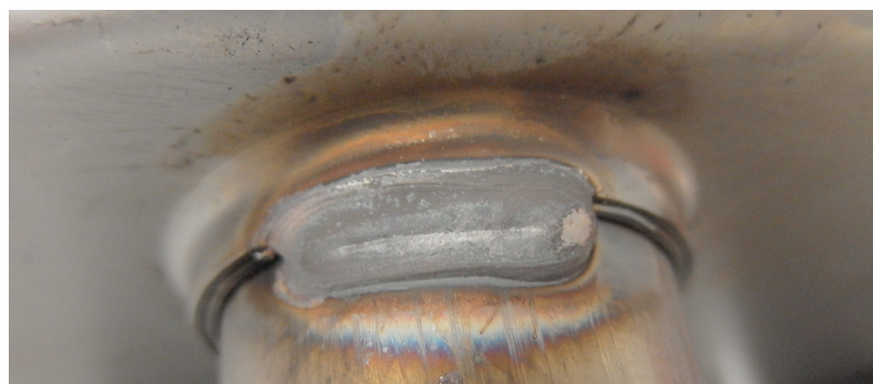
Obrázek 34: Proces KF-PULS, svar č. 1 koutový vícevrstvý přeplátovaný
