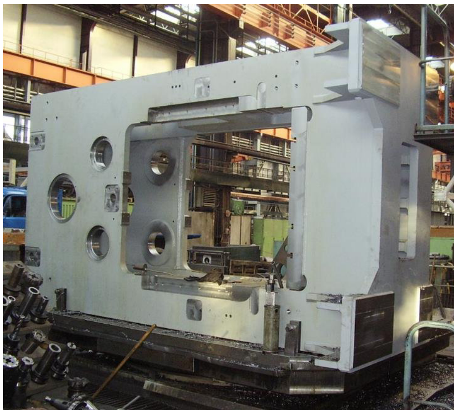
Obr. 4 Svařovaný stojan lisu [3]
