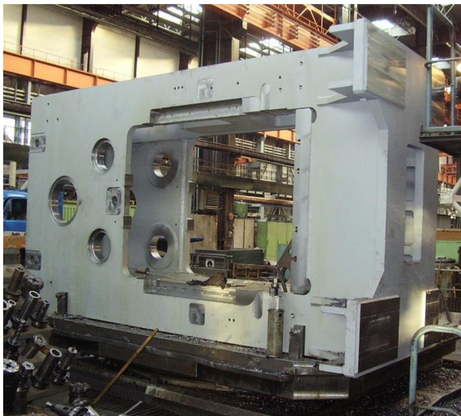
Obr. 4 Svařovaný stojan lisu [3]
