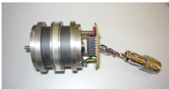
Obrázek 22 | Použité pohybové zařízení s integrovanými zesilovači (bez pouzdra).
