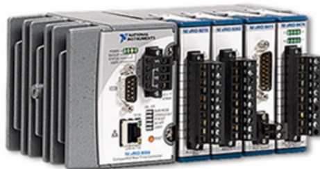
Obrázek 20 | CompactRIO sestava – kontrolér NI cRIO-9002, a čtyři I/O moduly [12].
