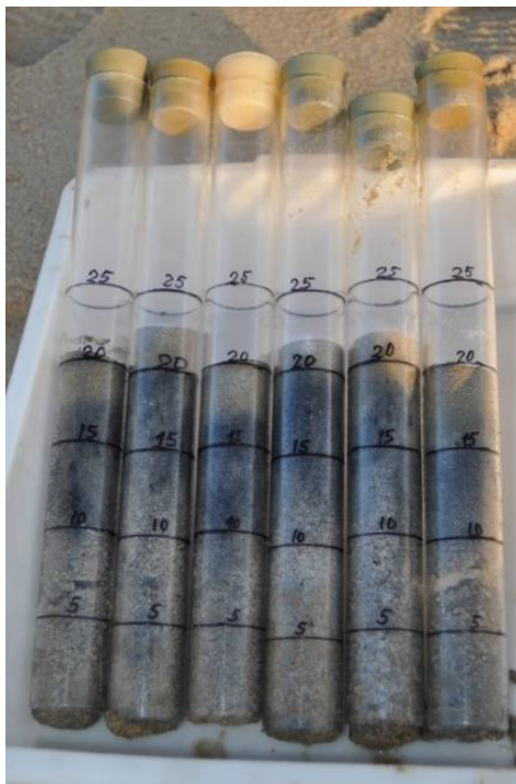
Obrázek č. 4 a č. 5: Sondy pro vertikální odběr sedimentu - odběr vzorků na ostrově Sylt (zdroj: archiv Doc. RNDr. Martin Rulík, PhD.)
