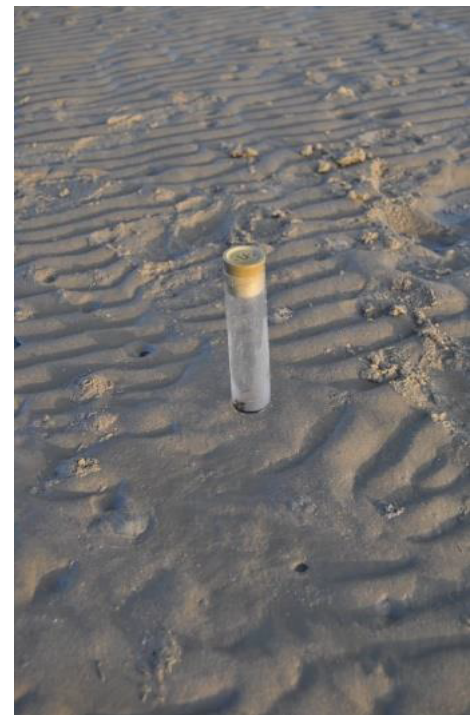
Obrázek č. 4 a č. 5: Sondy pro vertikální odběr sedimentu - odběr vzorků na ostrově Sylt (zdroj: archiv Doc. RNDr. Martin Rulík, PhD.)
