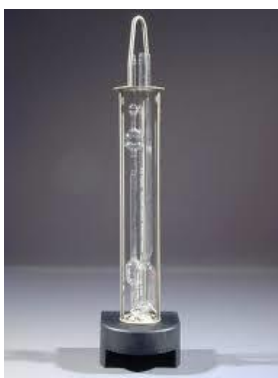
Obr. 5.3 Ubbelohdeho viskozimetr pro stanovení viskozity zkušebních vzorků bionafty ze slunečnicového a řepkového oleje
