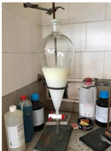
Obr. 4.12 Oddělování destilované vody z řepkového oleje
