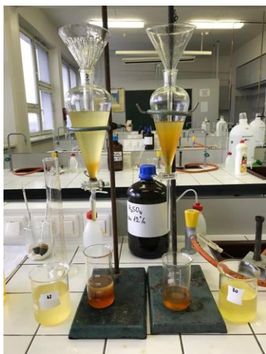
Obr. 4.13 Oddělování glycerolu ze slunečnicového a řepkové oleje
