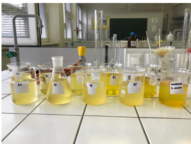
Obr. 4.15 Výstupní materiál – bionafta ze slunečnicového a řepkého oleje
