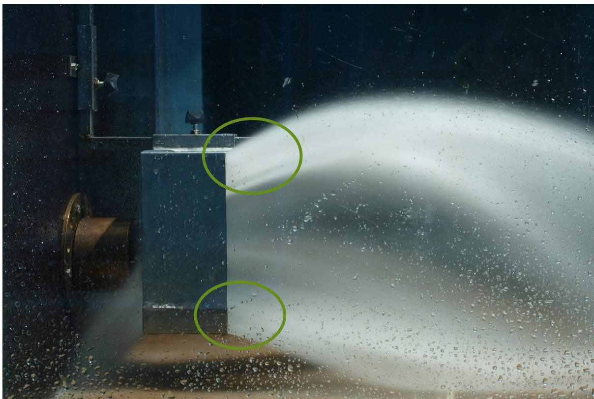
obr. 1.10 Přestřik výstupního proudu na modelu UP mimo obrys jeho výstupního průřezu
