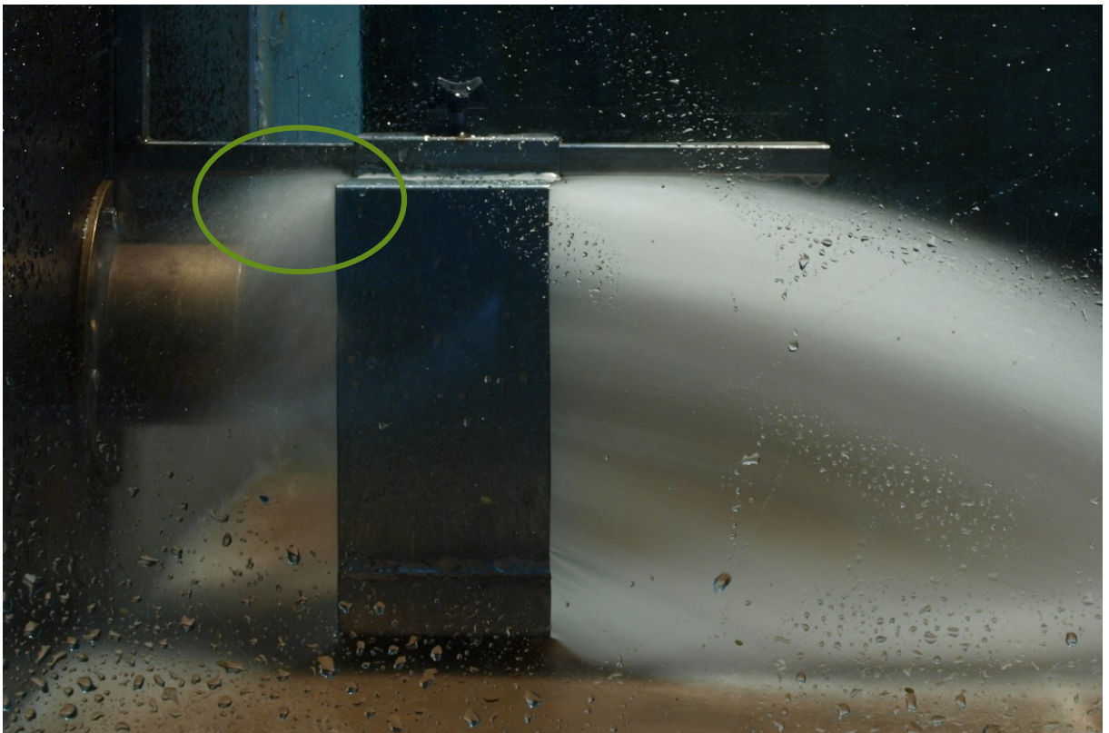
obr. 1.9 Zpětný ostřík na modelu RU a UP v hydraulickém žlabu v laboratoři
