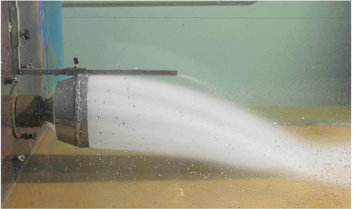
obr. 6.9 Usměrnění výstupního proudu při otevření a/D = 0,57 upraveným usměřňovacím prvkem
