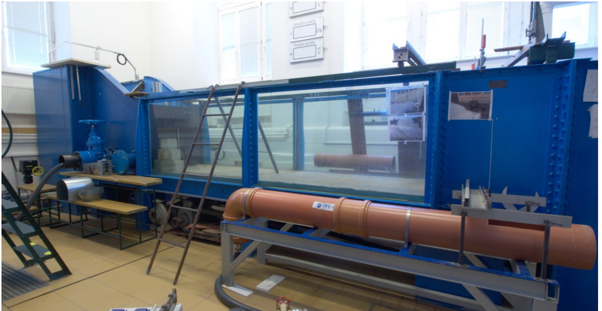
obr. 4.1 Pohled na hydraulický žlab s vloženou příčnou stěnou, na které je umístěn model RU
