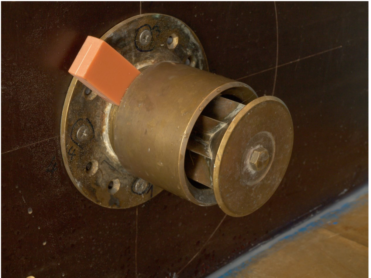
obr. 4.4 Užití distančního prizmata pro přesné nastavení otevření uzávěru
