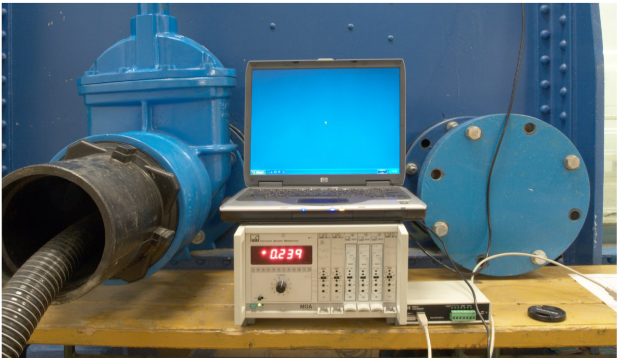
obr. 4.6 Měřicí můstek, A/D převodník a PC k ukládání dat
