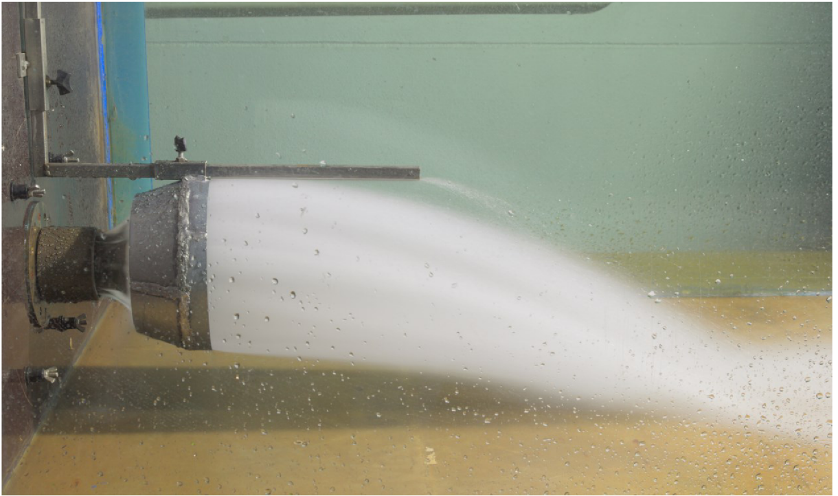
obr. 6.9 Usměrnění výstupního proudu při otevření a/D = 0,57 upraveným usměřňovacím prvkem
