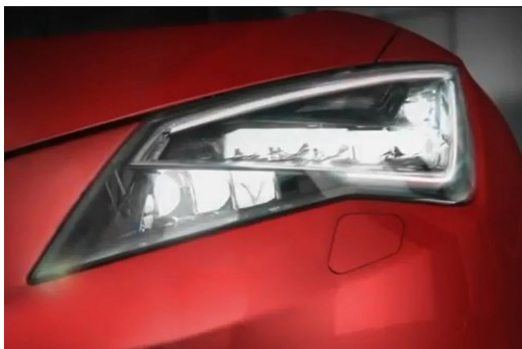
Obr. 4.7 Hlavní světlomet složený výhradně z LED diod (Seat Leon) 29
