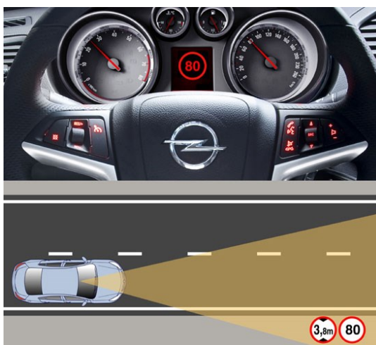
Obr. 4.5 Systém Opel Eye pro rozpoznání dopravních značek 27
