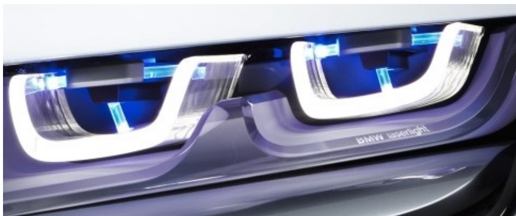
Obr. 4.8 Laserový světlomet představený na konceptu BMW i8 30
