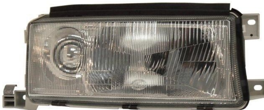
Obr. 4.9 Stupňovitý paraboloidní reflektor (Škoda Octavia 1998) 32
