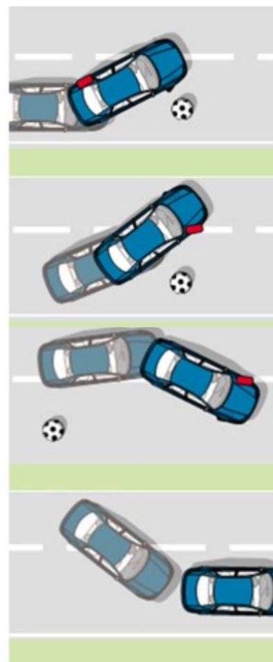
Obr. 5.18 Eliminace smyku pomocí ESP 61
