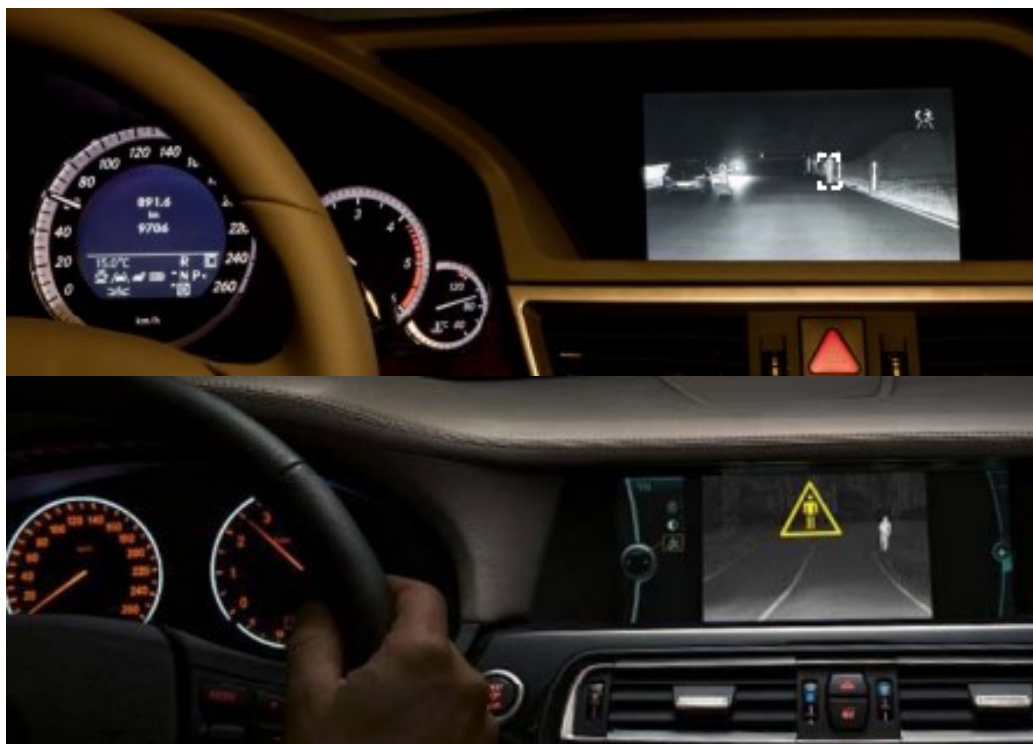
Obr. 4.15 Systémy nočního vidění s detekcí chodců NIR (nahore, Mercedes-Benz třídy E), FIR (dolní obrázek, BMW řady 7) 39
