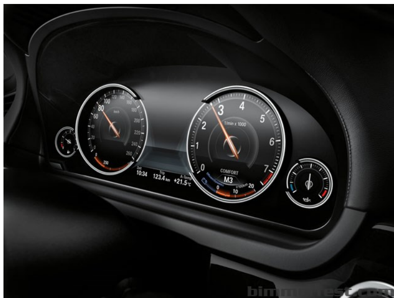
Obr. 2.11 TFT display místo klasického analogového přístrojového štítu (BMW 7 F01) 13
