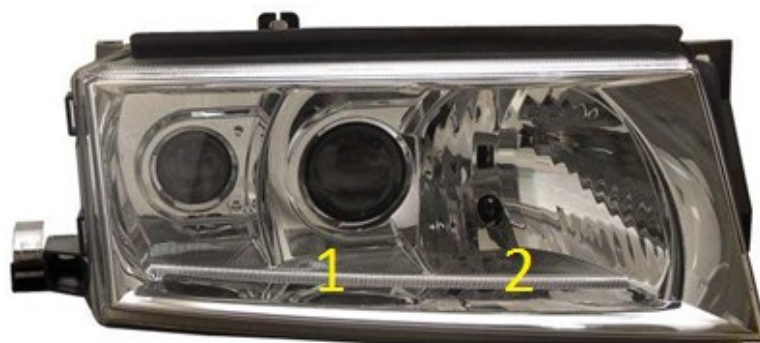
Obr. 4.10 Světlomet kombinující 1) projekční optiku, 2) reflektor s volnými plochami (Škoda Octavia 2001) 33
