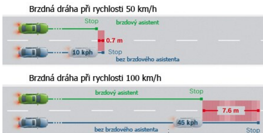
Obr. 5.15 Brzdné dráhy bez použití a s použitím brzdového asistenta 57
